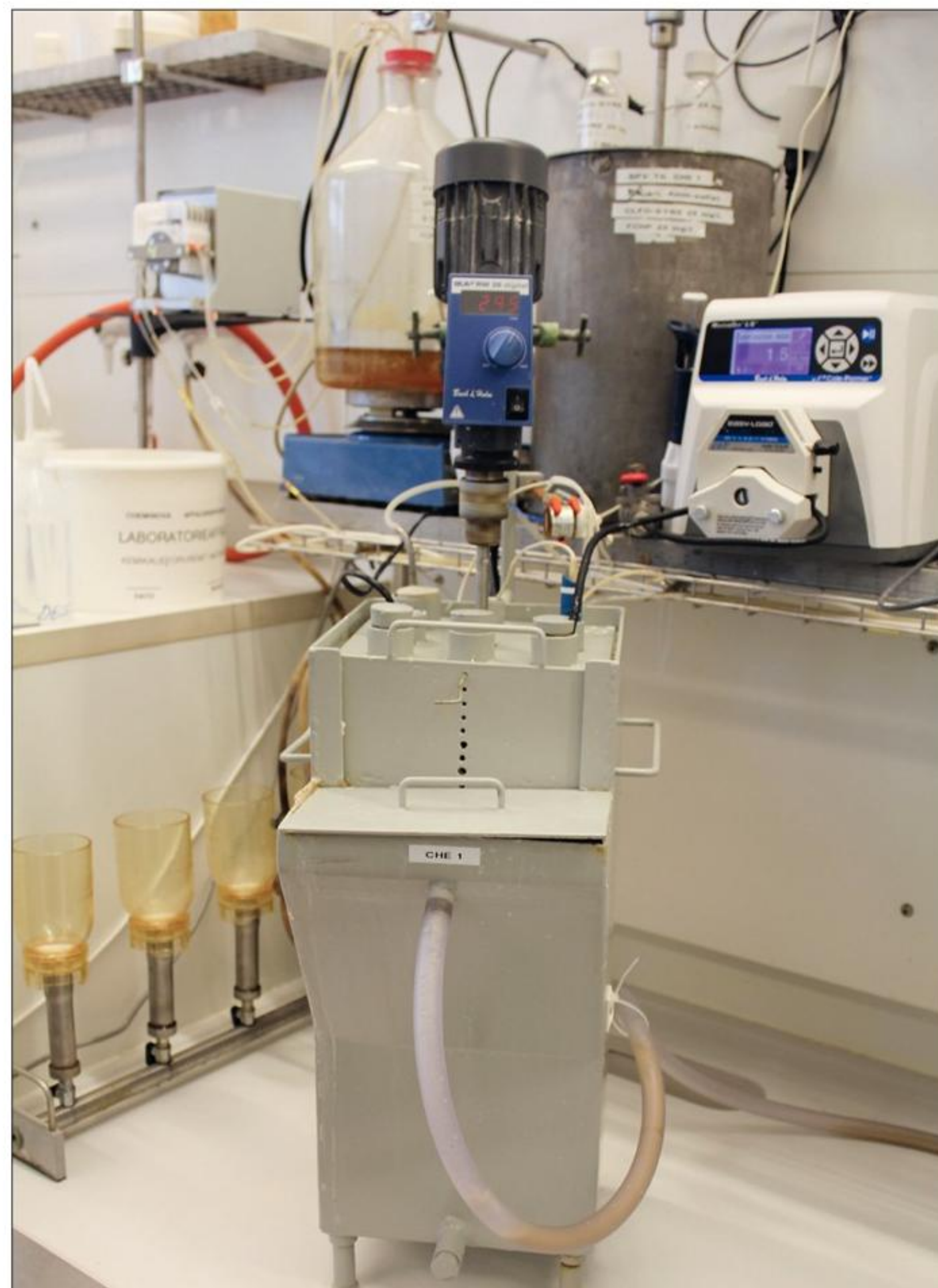
Chemostaten er koblet op med tilledningspumpe, omrøring og udtag til måling af temperatur og pH.
