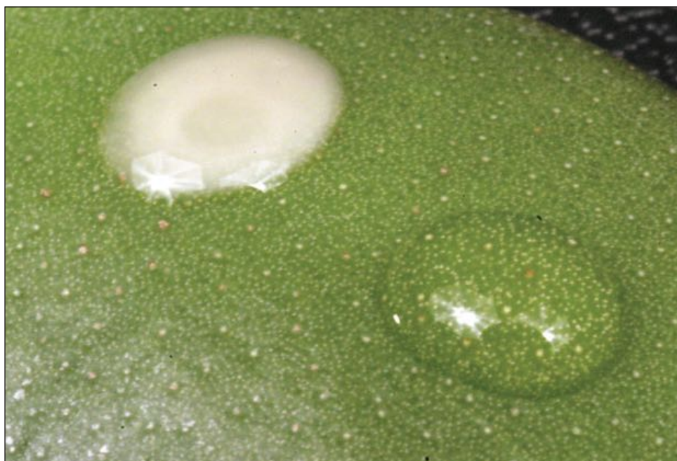
Le liquide transparent à la surface de la feuille est un herbicide animé par Solumax®. Il est complètement dissous, pour l'obtention d'une solution claire. L'herbicide DF (pâte granulée) est trouble, car ses particules sont simplement en suspension.
